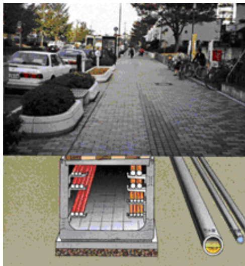
Strada infrastrutturata con cunicolo tecnologico
