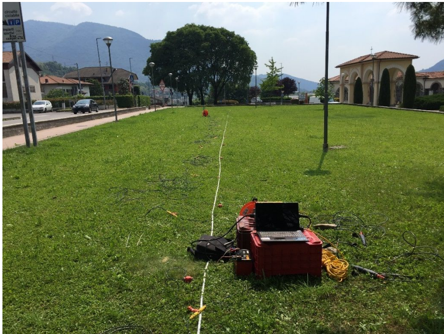
Figura 23 – Strumentazione utilizzata per l'indagine di sismica a rifrazione (Tipo M.A.S.W.).
