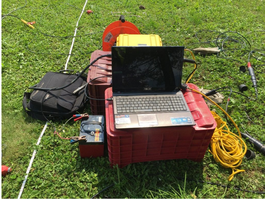
Figura 22 – Strumentazione utilizzata per l'indagine di sismica a rifrazione (Tipo M.A.S.W.).
