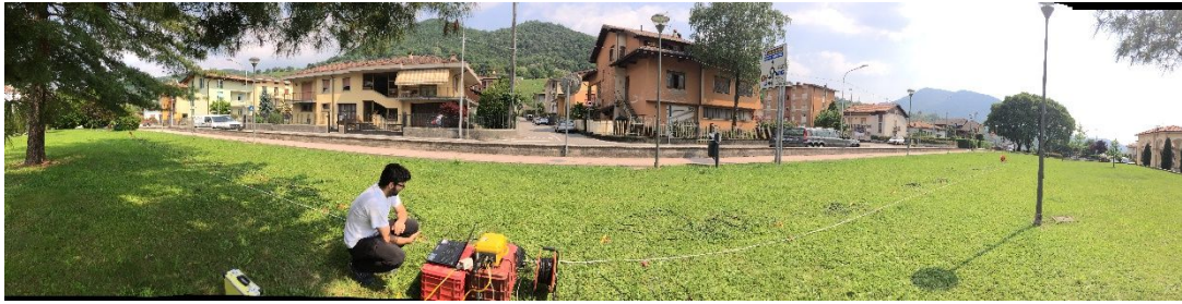
Figura 24 – Indagine M.A.S.W – Fasi di acquisizione – Area 1 “Cimitero”.
