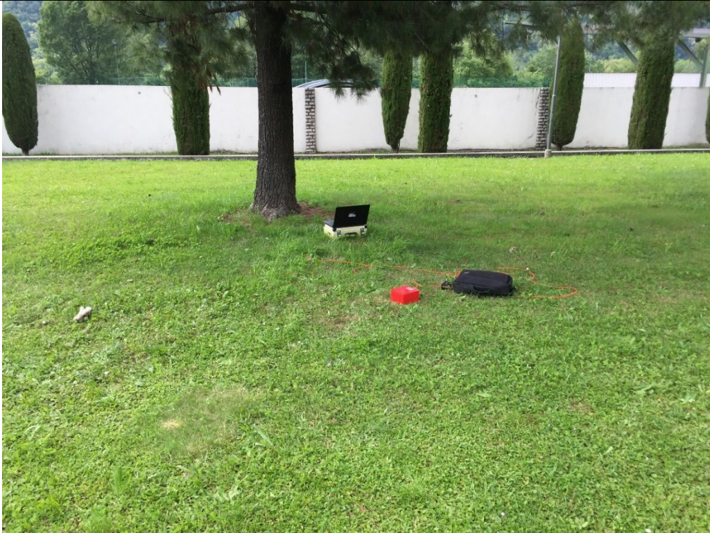
Figura 25 – Simografo geobox e velocimetro SS10 utilizzati per la registrazione dei microtremori.
