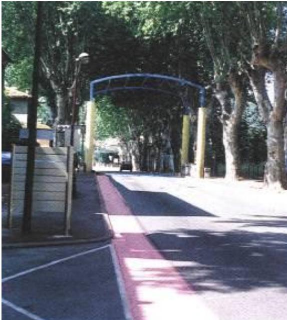
*Banchine transitabili al ciclo ai margini laterali di una strada in ingresso al centro di Piolenc (Francia); restringimento ottico della carreggiata come elemento di attenzione per l'automobilista, significazione della pluralità d'uso della strada*
