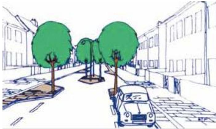
*Schema esemplificativo di disassamento planimetrico dell'asse stradale con isola centrale*
