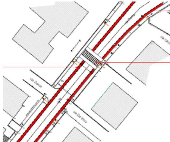
*Planimetria relativa allo sviluppo di banchine transitabili al ciclo su sezioni stradali di calibro modesto, che non permettono la realizzazione di piste ciclabili in sede propria o su corsia riservata*
