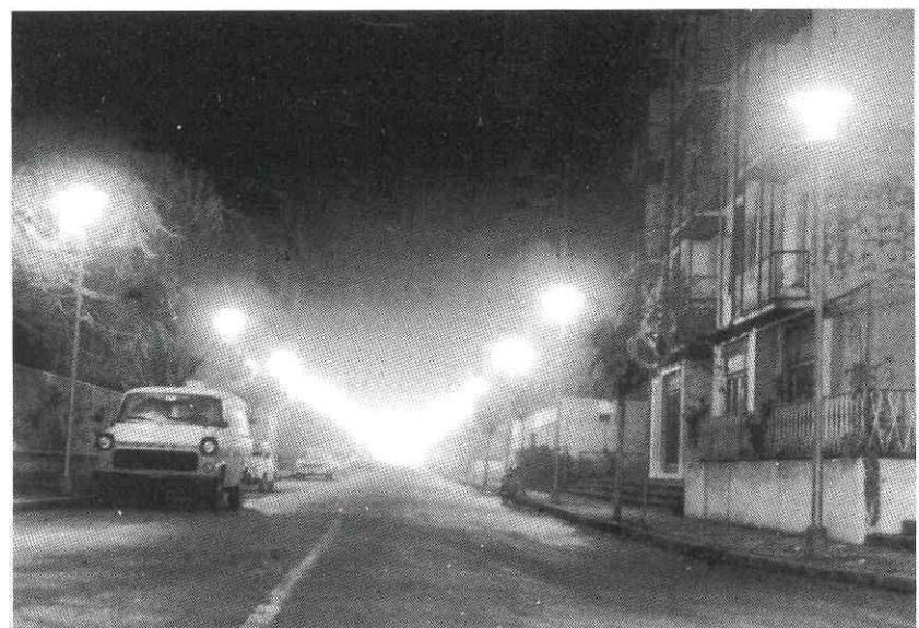
Visione notturna della via Barbò dopo la sostituzione delle lampade a vapori di mercurio con altre a vapori di sodio ad alta pressione.
