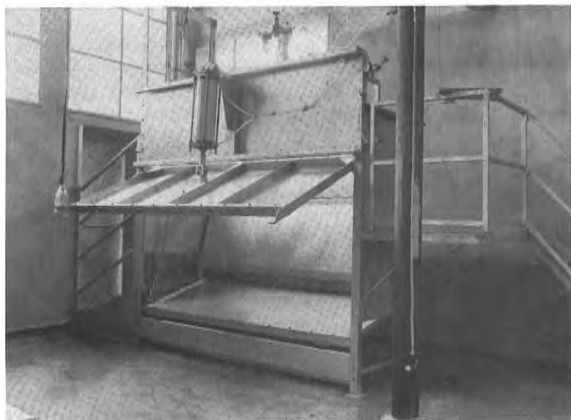
Ristrutturazione Macello Comunale - gabbia abbattimento animali.
