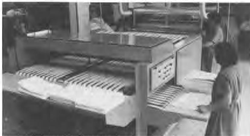
*Il Servizio Lavanderia è stato ulteriormente potenziato con l'introduzione di un mangano-calandra, in grado di asciugare e stirare fino a 25 m.l. di biancheria al minuto e di una piegatrice che permette di ottenere fino a tre pieghe longitudinali e due pieghe trasversali e di trattare capi di biancheria della dimensione massima di m. 1,60x3.*
